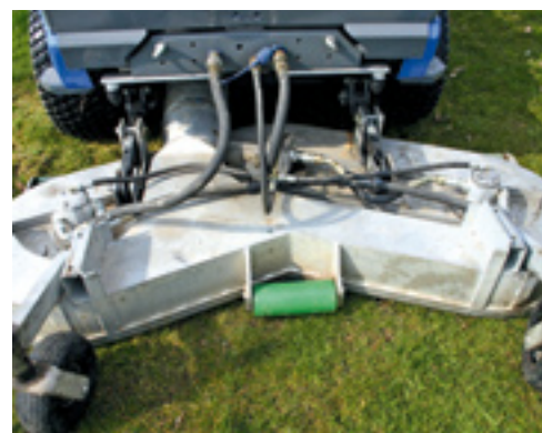
Het maaidek van 205 cm heeft drie messen die hydraulisch worden aangedreven.
