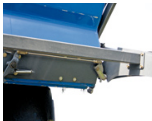
De klep wordt mechanisch ontgrendeld als de bak 45 graden schuin staat.
