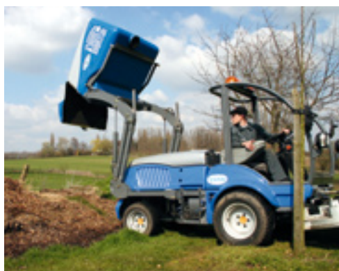
De bak steekt op 220 cm hoogte 74 cm achter het chassis uit. In een container lossen kan dus.
