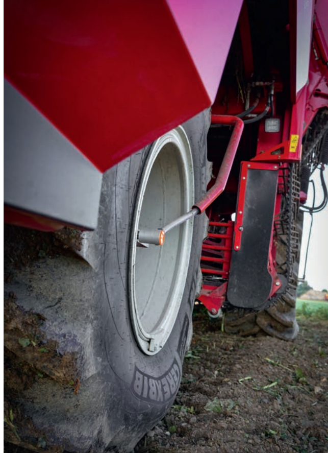
Met behulp van Terranimo kan de bodemimpact (verschil druk/ \text{cm}^2 ) van een lagere bandenspanning worden berekend
