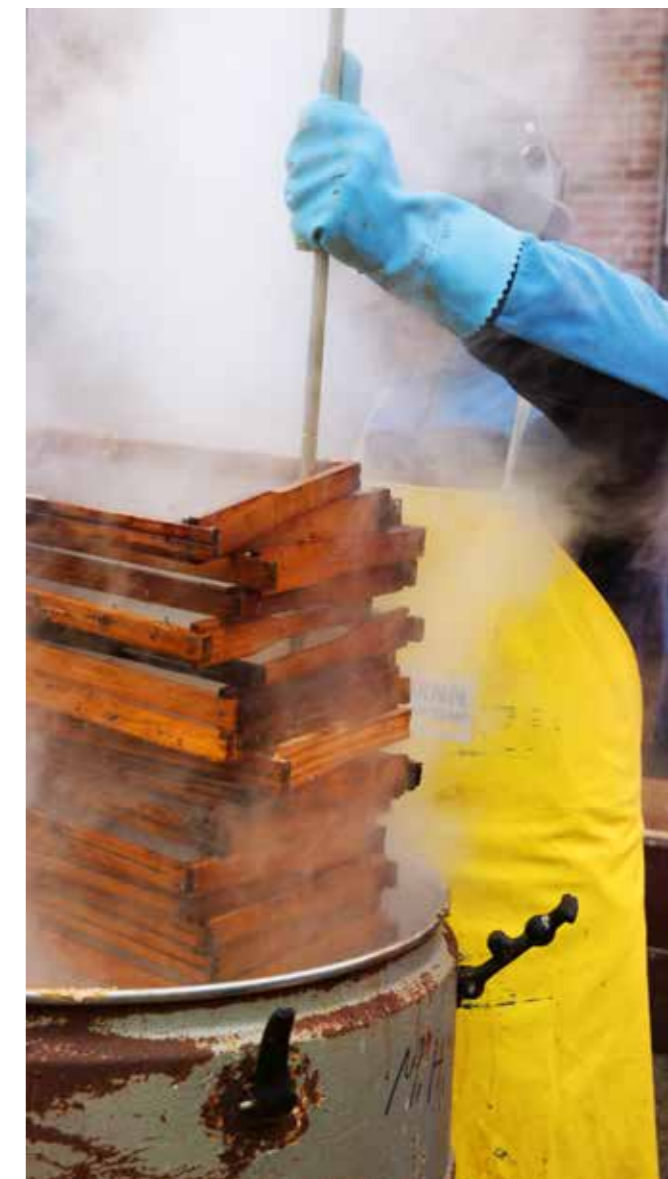
Onderdompelen in een heet bad met een 6%-oplossing van natronloog.
