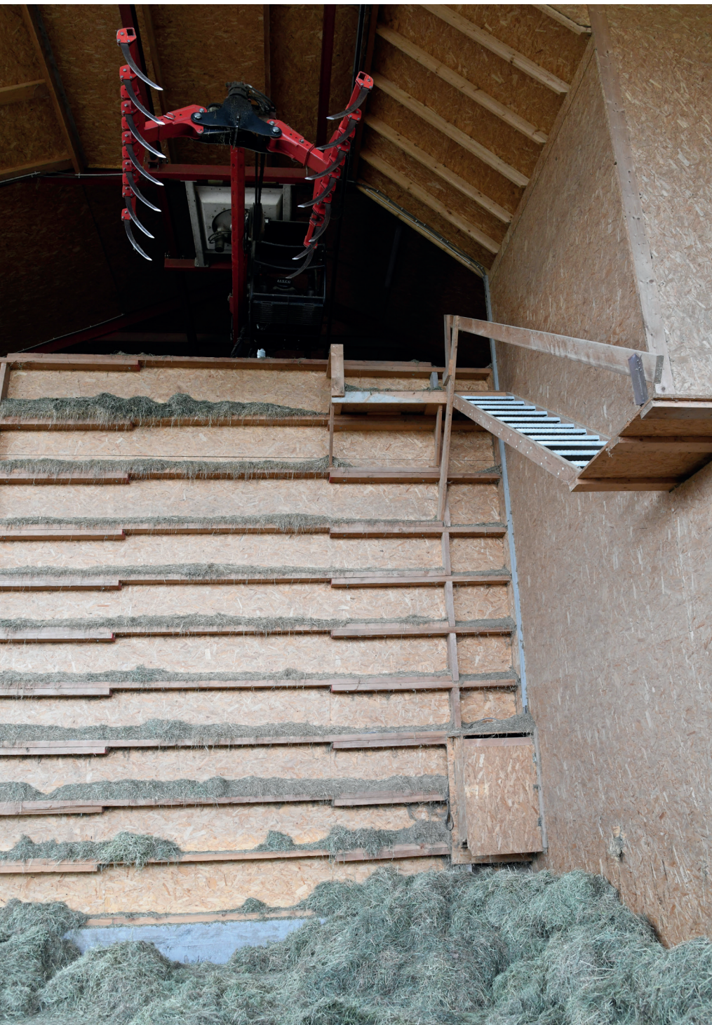
▲ Een kraan boven in de nok legt met een grijper het gras in de boxen
