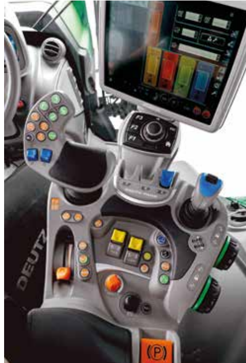
De nieuwe bediening met onderaan de nieuwe gashendel en op het dashboard de extra uitstroomopening.
