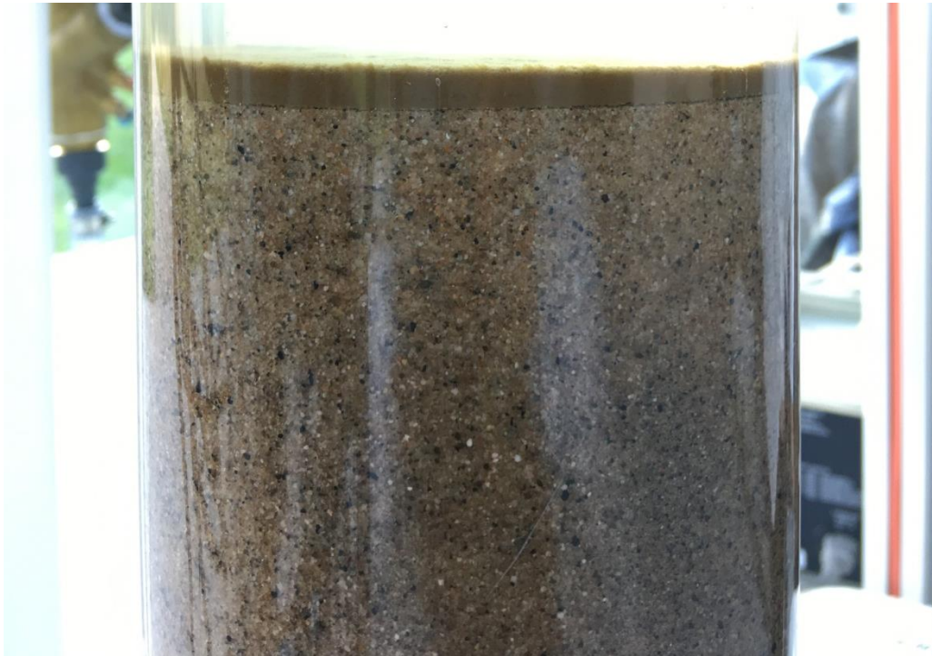
FIGUUR 2-1 BEZINKSEL OP HET FILTER, DIT IS VOOR DE PROEF VERWIJDERD DOOR AFZUIGEN
