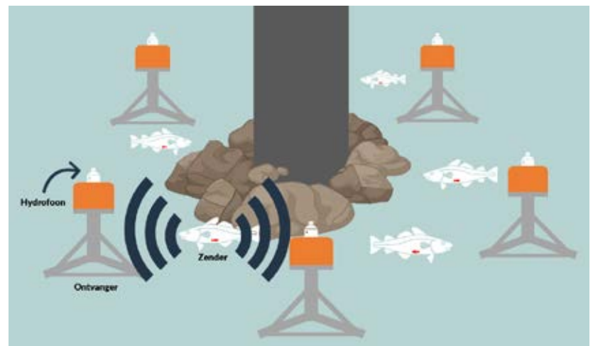
Schematische weergave van het geluidsonderzoek in open zee.
