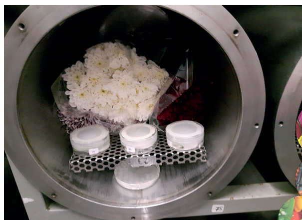
Figuur 1 | Proefopstelling om CATT-condities te testen op snijchrysant en trips.
