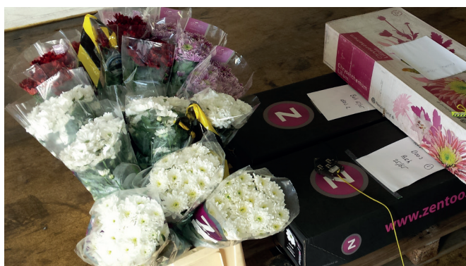
Figuur 2 | Proefopstelling om het effect van verpakking op de indringing van warmte te bepalen.
