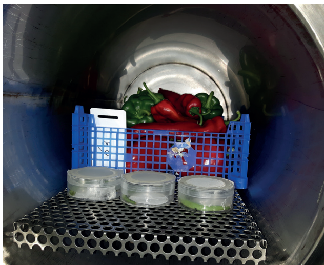
Figuur 2| Proefopstelling om CATT-condities te testen op paprika en trips
