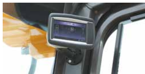
Een verbruiksmonitor met ladingsindicatie is in de cabine de enige aanwijzing dat het om een elektrische machine gaat.
