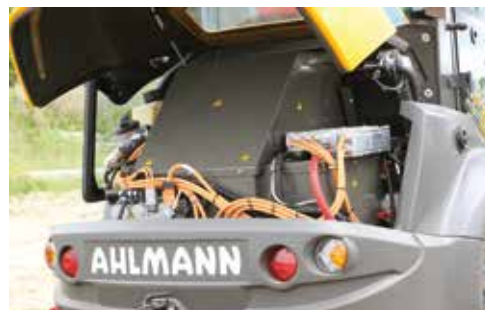
Geen diesel onder de kap, maar een flink accupakket en de bijbehorende regelunits. Alles past onder de bestaande kap.
