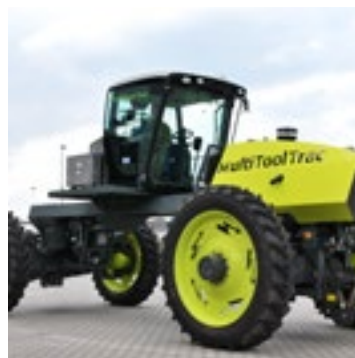
Bij de T220 kun je aan zowel de voorkant als in het midden als aan de achterkant werktuigen monteren. Deze grote constructie maakt de machine wel erg zwaar: ongeveer 10 ton.
