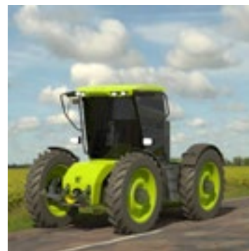
De E120 is aanmerkelijk kleiner en lichter dan de T220. De fabrikant verwacht dat de trekker 6,5 ton gaat wegen. Doordat alle onderdelen in het frame verwerkt zijn, heb je vanuit de cabine goed zicht.
