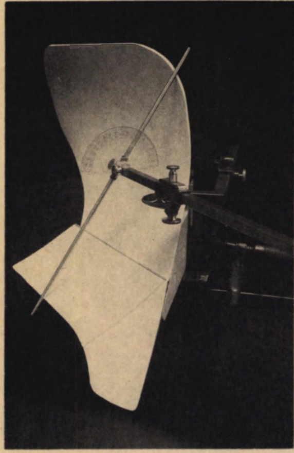
2 Het bepalen van de richting van de verbindingslijn tussen rasteronder- en -bovenkant.
