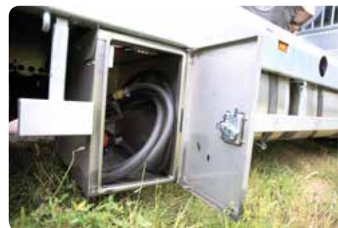
Dankzij twee grote dieseltanks en een elektrische pomp kunnen voertuigen op locatie worden afgetankt.
