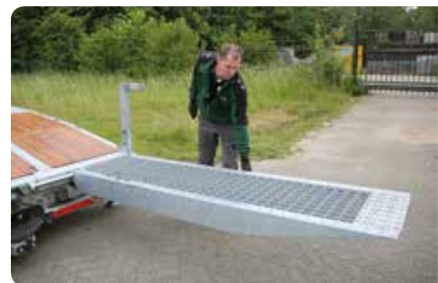
Het op- en uitklappen van de rijplaten gaat handmatig sneller dan hydraulisch. Dankzij de veerconstructie is er weinig kracht nodig.
