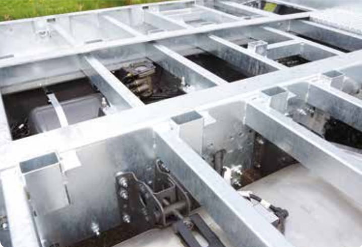
Domex staalplaten liggen langs het laadframe van de Volvo. De dwarsbalken lopen over de volle breedte van de laadvloer.
