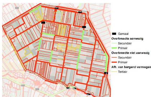
Figuur 4.15 Overbreedte van watergangen in de Wieringerwaard.
