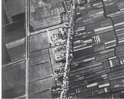
Figuur 7.3 Een luchtfoto uit 1979 geeft aan weerszijden van de lintbebouwing de nieuwe en de oude kavelindeling aan (Foto: Dienst Landelijk Gebied in Andela 2000)
