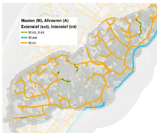
Figuur 4.15 Gepland onderhoud van het nat profiel van watergangen in de Gemeenschappelijke polders in 2018 volgens gegevens van het waterschap. Intensief maaien is minimaal 2 × per jaar van 15/6 tot 1/8 en 15/9 tot 18/10. Extensief maaien is gepland 1 × per jaar van 15/9 tot 18/10.
