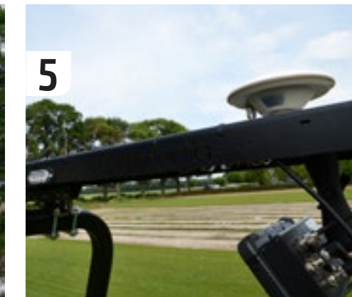
5 Bij de cabine-loze Roberine wordt een beugel voor montage van de bedieningsterminal en gnss-antenne geleverd inclusief flitsers.
