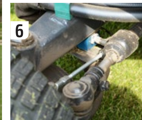
6 De Roberine F5 wordt voorzien van een stuurhoek-sensor om de wieluitslag te kunnen meten voor automatisch sturen.
