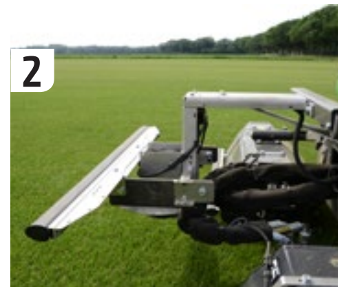
2 TerraTroniq levert voor elke machine op maat gemaakte montagekits voor de scanners, bumpers en antenne.
