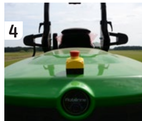
4 Een kwestie voor het verkrijgen van CE-keur is een dodemansknop waarmee de machine abrupt uitgeschakeld wordt.
