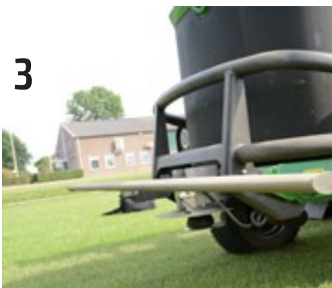
3 De machine rijdt ook autonoom achteruit, bijvoorbeeld om te keren als de buitenste werkgang in een scherpe hoek genaderd wordt.
