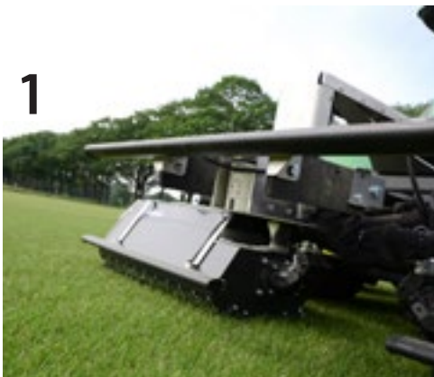
1 Twee lasercamera's verkennen de omgeving op obstakels. De bumpers zijn een extra slot op de deur. Vier van de vijf klepelunits hebben eigen bumpers.
