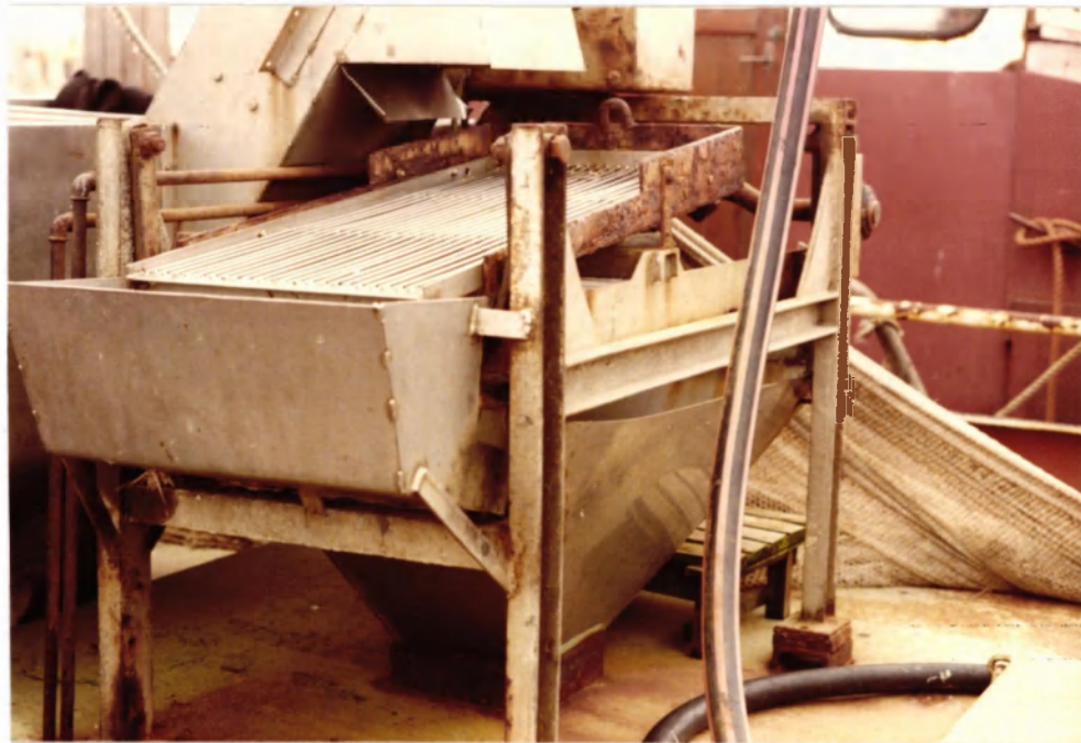
Foto 2 - Beter type schudzeef met opvoerband. De bovenste zeefmat is volkomen glad, zodat beschadiging van de vis nihil is. De afvoer van vispuf geschiedt door een trechtersvormige opvangbak die zich gedeeltelijk onder de zeef bevindt. Via een pijp gaan ondermaatse garnalen en vispuf tenslotte overboord.
