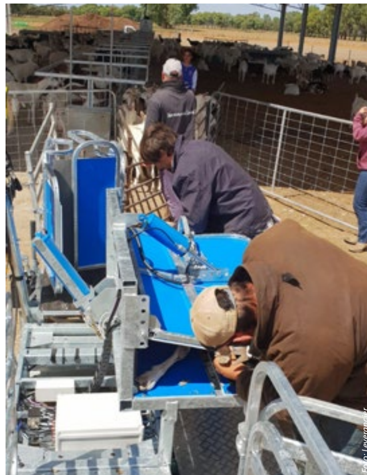
Deze variant van de Racewell selectieboxen kan de dieren klemmen en 90 graden draaien, zodat klauwtjes bekappen mogelijk wordt.
