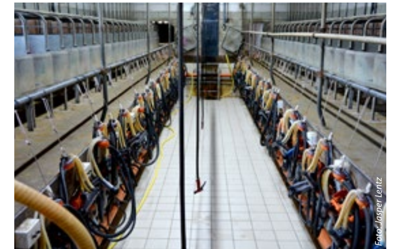
De huidige 2x30 zij-aan-zij melkstal wordt in de nabije toekomst vervangen door een carrousel. Dat zal de melktijd met de helft reduceren.
