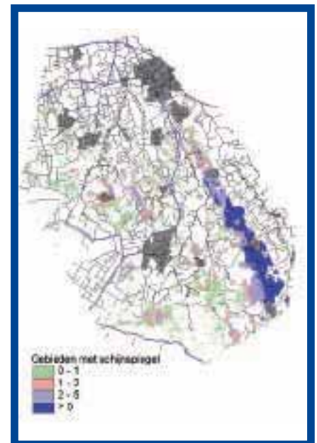
Afb. 5: Gebieden waar SIMGRO een schijngrondwaterspiegel voorspelt voor 27 november 1992. Weergegeven is de afstand (in meters) tussen de onderkant van de keileemlaag en de grondwaterstand in laag 3.
