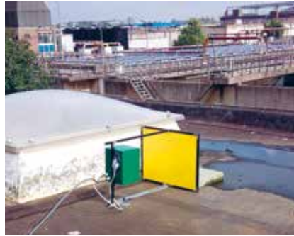
Figuur 7. Camera met geel scherm opgesteld op een bitumen dak.
