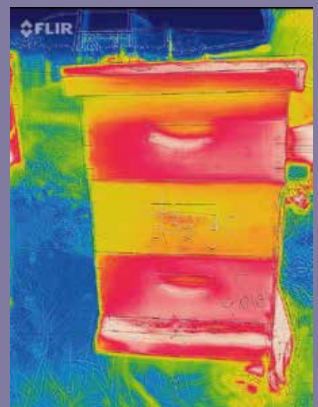
Thermografie: De rode gedeelten zijn het warmst, gevolgd door de gele en groene. Bij de blauwe gedeelten is de kast het koudst. Foto's Kayla Heywood
