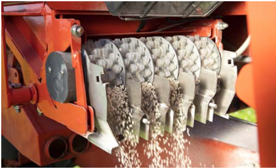
Elke doseerrad kan een eigen draaisnelheid aannemen en daardoor de dosering aanpassen per 1,2 meter werkbreedte.
