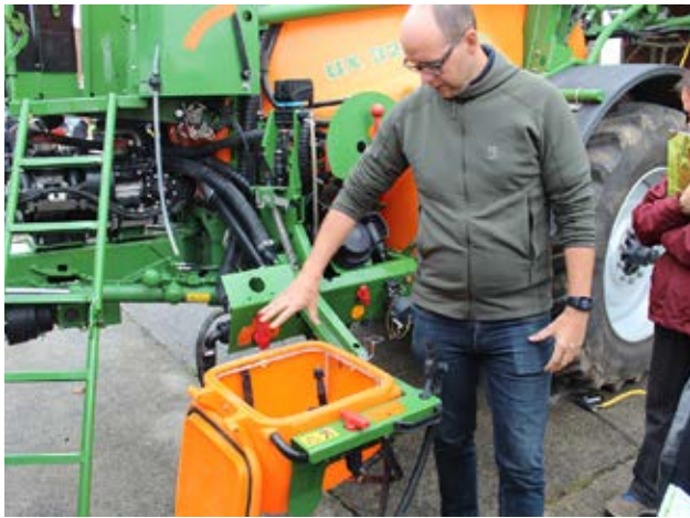
Met deze aparte tank kan men op het veld zelf de sproeitank reinigen en het spoelwater uitrijden.
