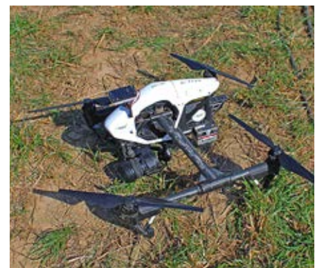
Deze drone is uitgerust met een gewone visuele (en lichte) camera om de actieradius te vergroten.
