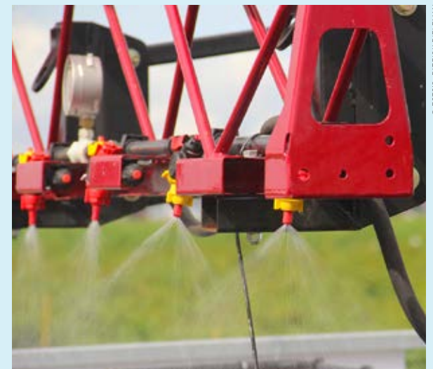
Driftreducerende doppen leveren grotere druppels, maar met de juiste druk en waterhoeveelheid bereik je toch een goede bedekking van het gewas.
