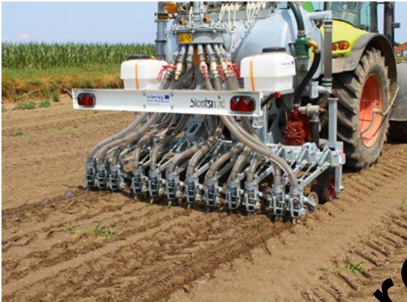
De proefveldbemester in actie tijdens de demo. De vloeistof wordt mooi in de sleuven toegediend.
