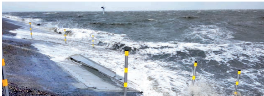
Afbeelding 5: Meerjarige Veldmetingen: In het buitentalud ingegraven golfoverslagbakken
