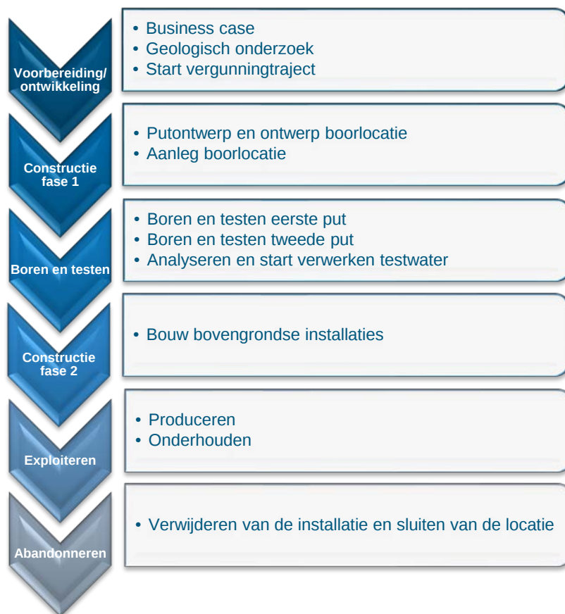
Figuur 3.1: Vereenvoudigd doorloopschema van typisch geothermieproject met een normale doorlooptijd van circa 3 jaar voor de ontwikkeling van een geothermieproject tot aan productie.
