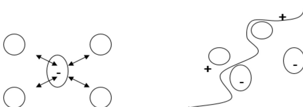
A : (metaal)deeltjes in water B: door toevoeging van coagulant en polymeer ontstaat een bezinkbare vlok
