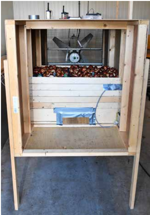
In een proefopstelling van de supergaasbak is onder meer nagegaan hoe dik de bollenlaag kon zijn voor een goed bewaarproces.
