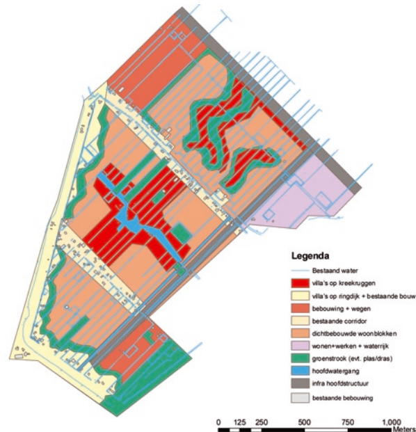
Figuur 36: Uitwerking van de compartimenteringsmethode, met een verhoogd aangelegde N 219 en handhaving van de slotenstructuur
