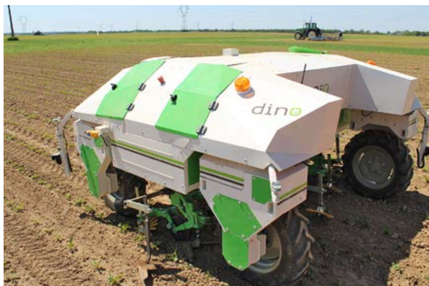
De uit de groenteteelt meegebrachte robot, gestuurd door gps, kan een perceel onderhouden zonder menselijke arbeid.
