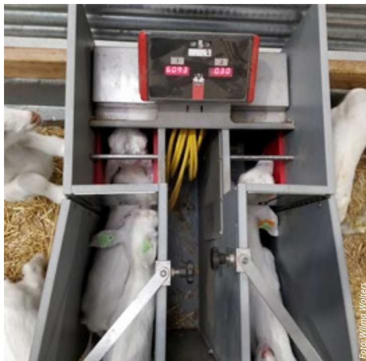
De drinkautomaat verstrekt elk lam melk volgens een ingestelde curve.
