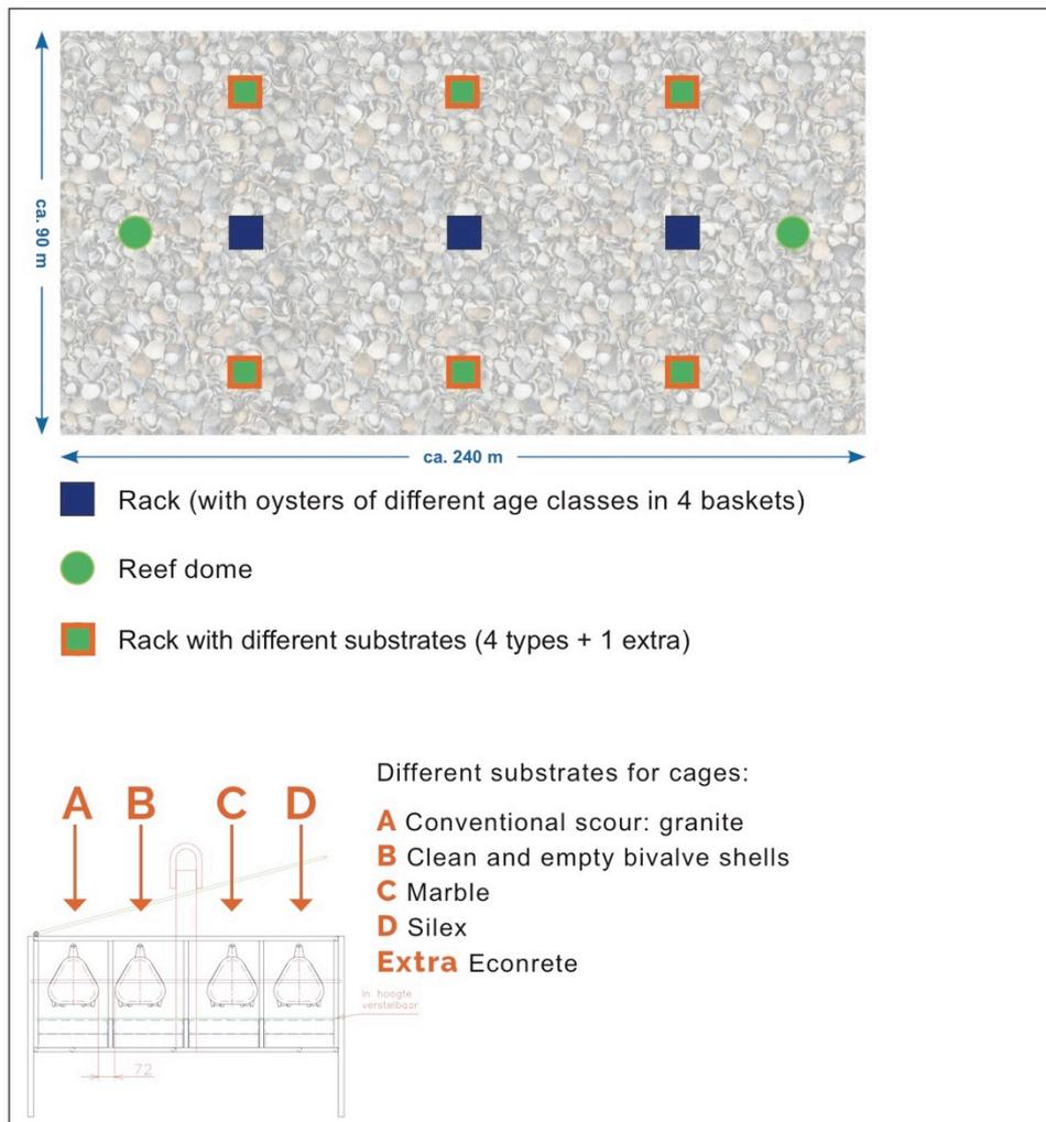
Figure 2. Design of Luchterduinen oyster pilot.
