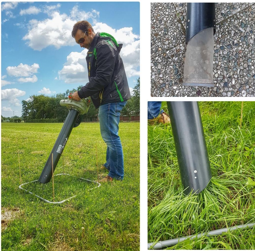
Foto 2.4. Apparaat dat werd gebruikt voor het verzamelen van grasknipsels. Het netje in de zuigmond vangt de grasknipsels op die binnen het pvc-frame van 55 x 55 cm 2 zijn opgezogen.
