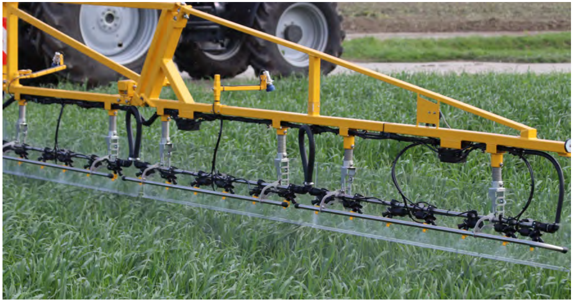
Het Dubex Wave systeem (sleepdoektechniek).
