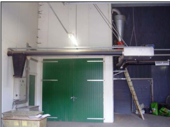
J. Buitenaanzicht van de stromachine, met vulplaats (achter de groene deuren) en stroleidingen (zwart)
