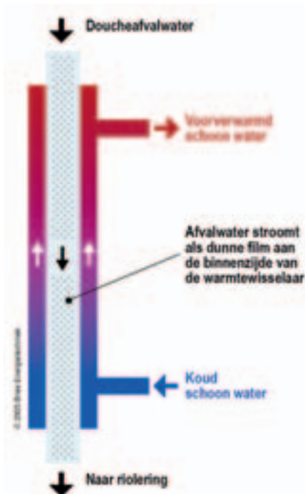
Figuur 1: Principe douchewarmtewisselaar.
