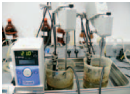
Figuur 1: meetopstelling t.b.v. bepaling nitrificatiesnelheid (links) en denitrificatiesnelheid (rechts).
