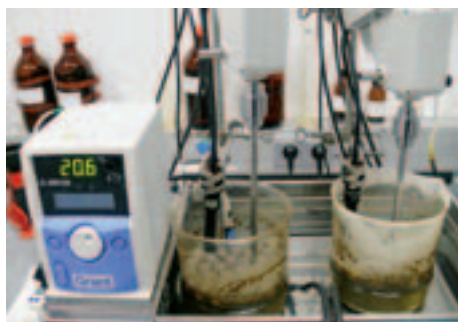
Figuur 1: meetopstelling t.b.v. bepaling nitrificatiesnelheid (links) en denitrificatiesnelheid (rechts).
