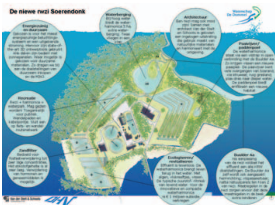
Afbeelding 1: Ontwerpschets rwzi Soerendonk met bijzondere aspecten toegelicht. Installatieonderdelen: 1 influentgemaal; 2 fijnroosters en zandvanger; 3 anaërobie tank en voordennitrificatie; 4 oxidatiesloot; 5 nabezinktanks en retourslibgemaal; 6 zandfilters; 7 flowformcascade; 8 vlooienvijvers; 9 moerassloten met riet en ondergedoken waterplanten; 10 biotoopvijver; 11 vistrap; 12 technisch gebouw met o.a. slibindikker, blowerruimte en chemicaliëndosering.
