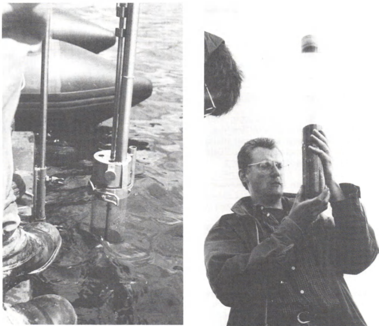
Fig. 2: Het gebruikte boorapparaat in werking (links) en de resulterende boorkern (foto's: Lucia Wick, Bern).
