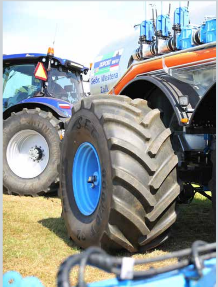
Duport maakte een speciale constructie voor de combinatie van schuifas en gestuurde tandem.
