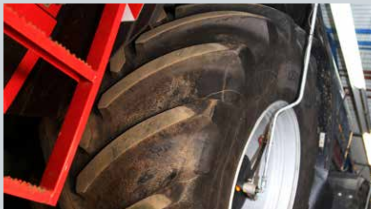
Een luchtdrukwisselsysteem bleek cruciaal om deze VF-banden optimaal te kunnen gebruiken.
