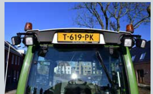
Het trekkerkenteken is geel, hoort bij een trekker en kan niet worden gewijzigd. Kentekens van tractoren en zelfrijdende werktuigen beginnen altijd met de letter T.
