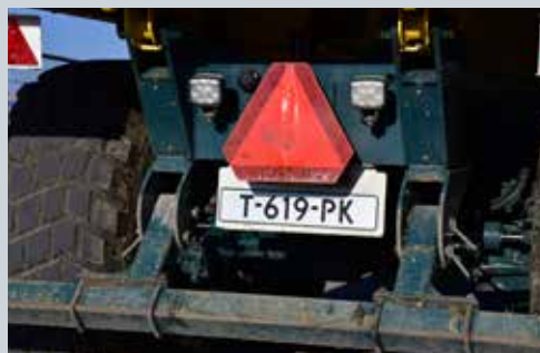
Een niet-geregistreerde aanhangwagen krijgt een witte kentekenplaat. Op deze plaat moet een kenteken staan van een (land)bouwvoertuig dat op het bedrijf is geregistreerd. Met een witte plaat mag je maximaal 25 km/u rijden.
