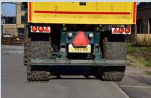
Geregistreerde aanhangwagens krijgen een eigen gele kentekenplaat. Deze is herkenbaar aan de L waarmee het kenteken begint. Met deze plaat mag je 40 km/u rijden.
