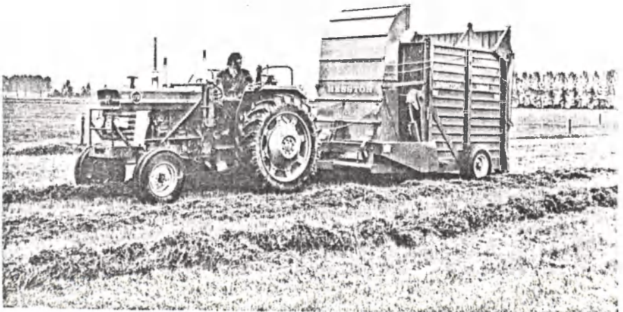
Afb. 2 Het geladen gras wordt met de kap samengeperst.
