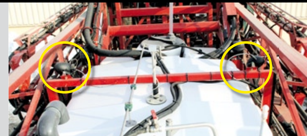
▲ Links en rechts van de tank zit een lamp voor boomverlichting.
