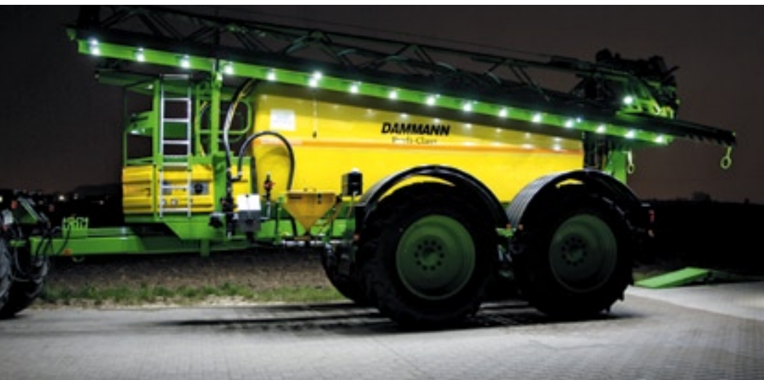
▲ De individuele dopverlichting van Dammann is ook handig in transportstand. Dan fungeert de dopverlichting als werkverlichting tijdens het vullen van de tank.
