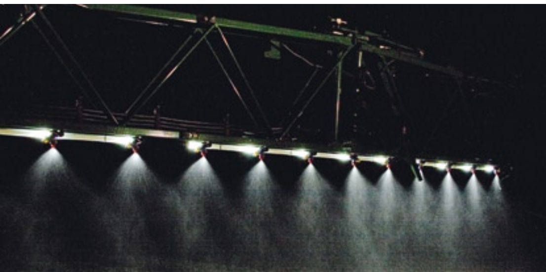
▲ Amazone heeft aan de volledige lengte van de boom een lichtslang met ledlampen die vanuit de spuitboom de dop en het spuitbeeld verlicht. Bij Dammann heeft elke dop een ledlamp.
