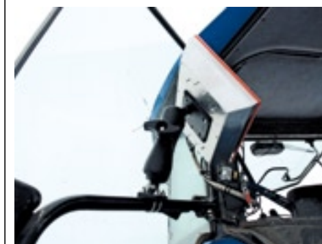
De terminal verstel je om twee kogels. Een veer tussen de kogelklemmer maakt uitwisselbaarheid van het display tussen trekkers groter
