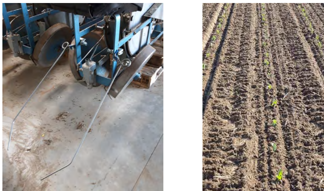
Figuur 6-12: Torsiewieders gemonteerd achter de plantelementen en het aandrukspoor dat ze nalaten.
