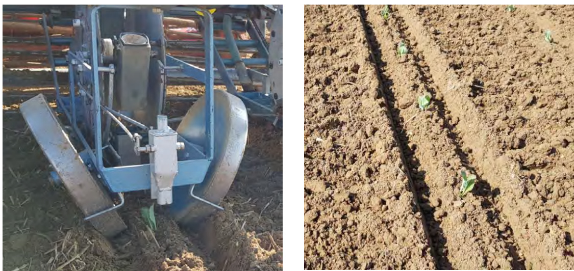
Figuur 6-11: De klassieke volle aandrukwielen en de aandrukrij die ze achterlaten na ploegen.
