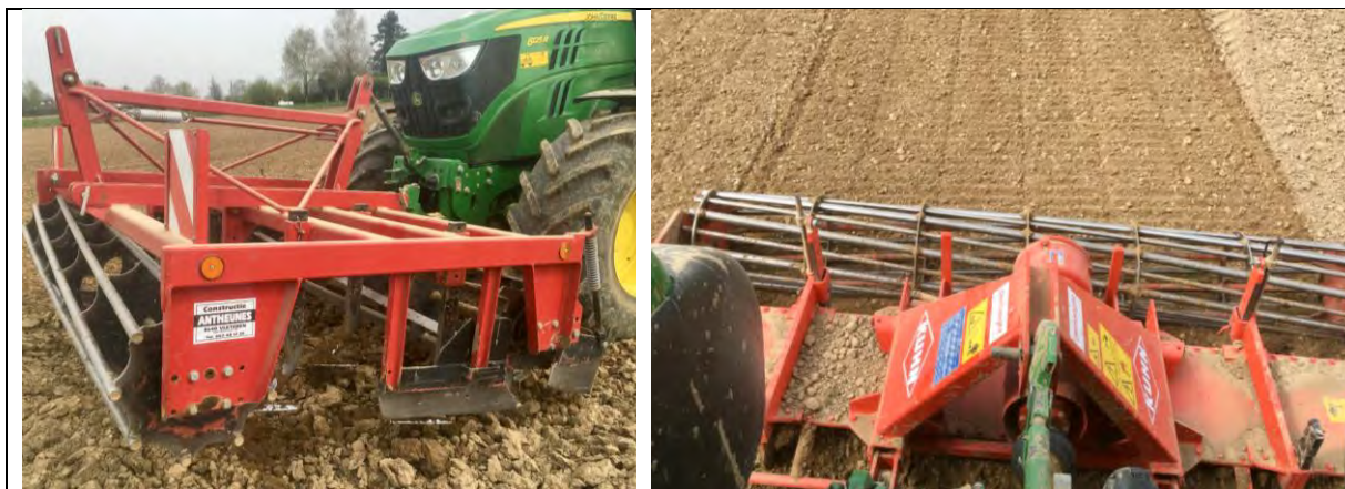
Figuur 4-6: vaste tandcultivator met open kooierol in de frontheef en rotoleg + open kooierol achter de trekker.
