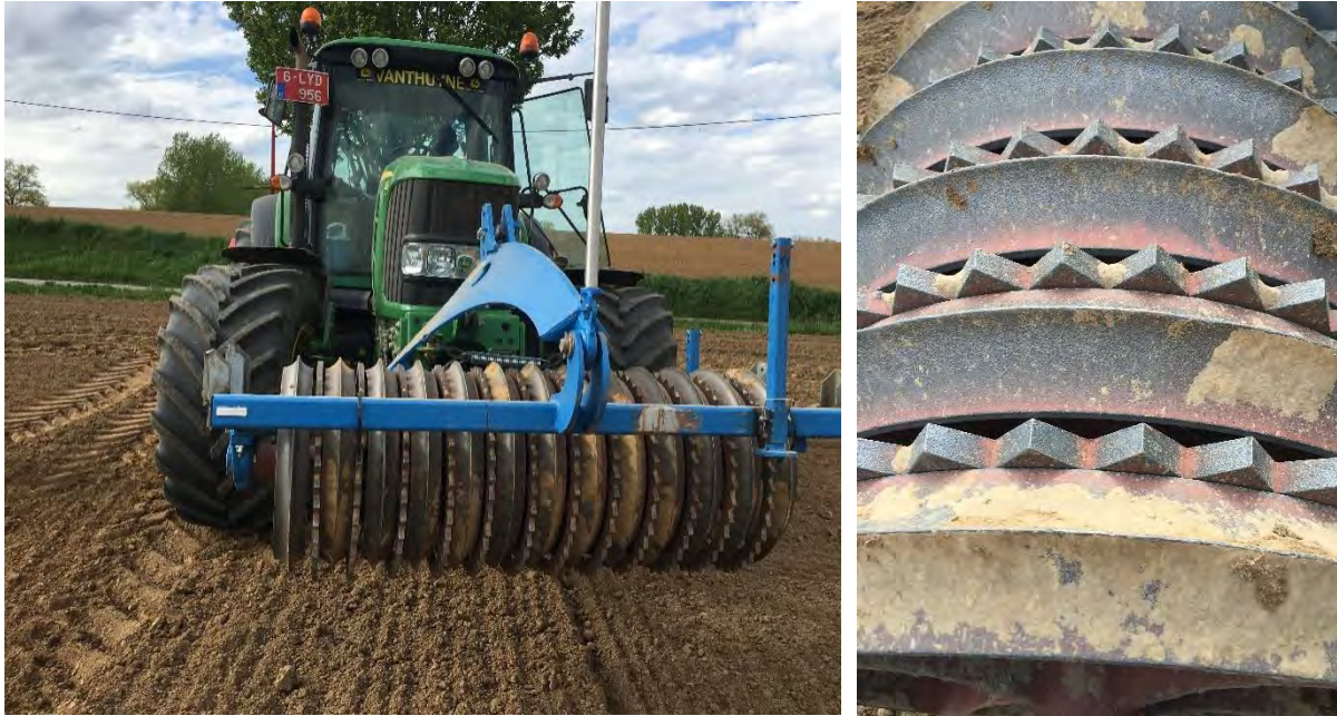
Figuur 2-9: Cambridgerol vooraan de trekker als frontgewicht en om grond aan te drukken en te verkrumelen.
