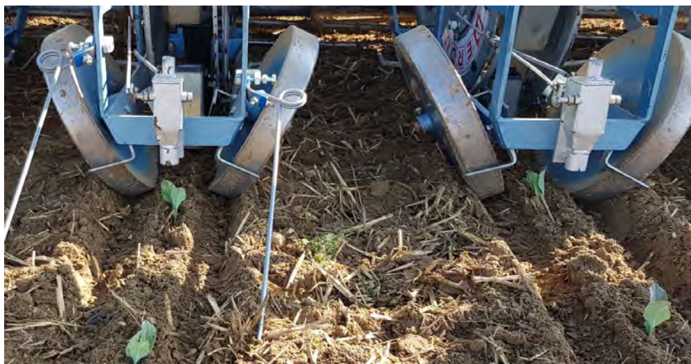
Figuur 6-5: torsiewieders gemonteerd achter het plantelement.
