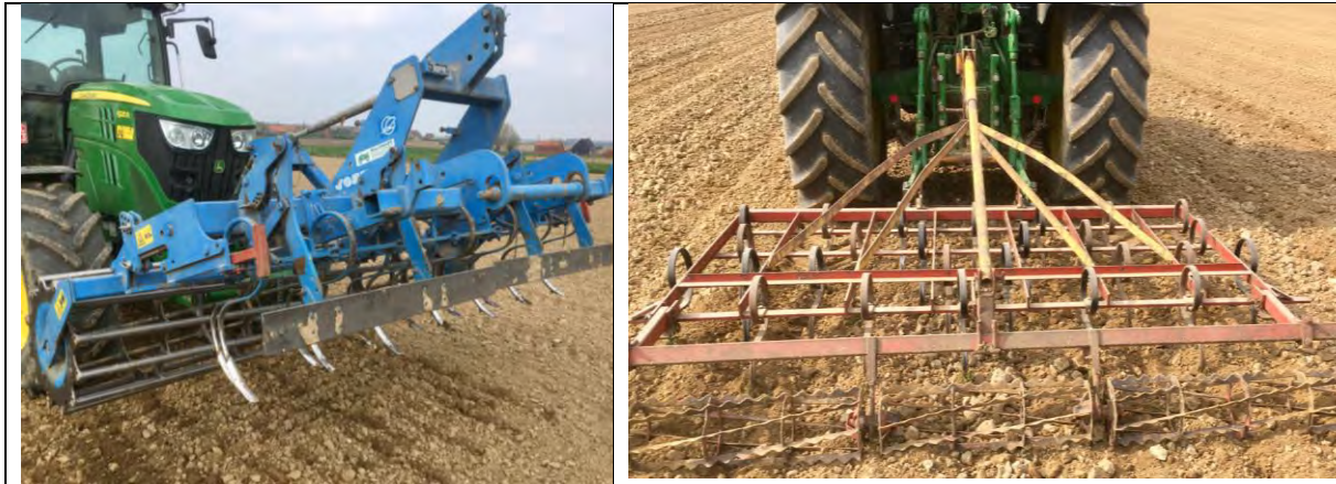
Figuur 4-7: Extensieve combinatie met 2 triltandcultivators gebruikt voor de zaaibedbereiding in object 2
