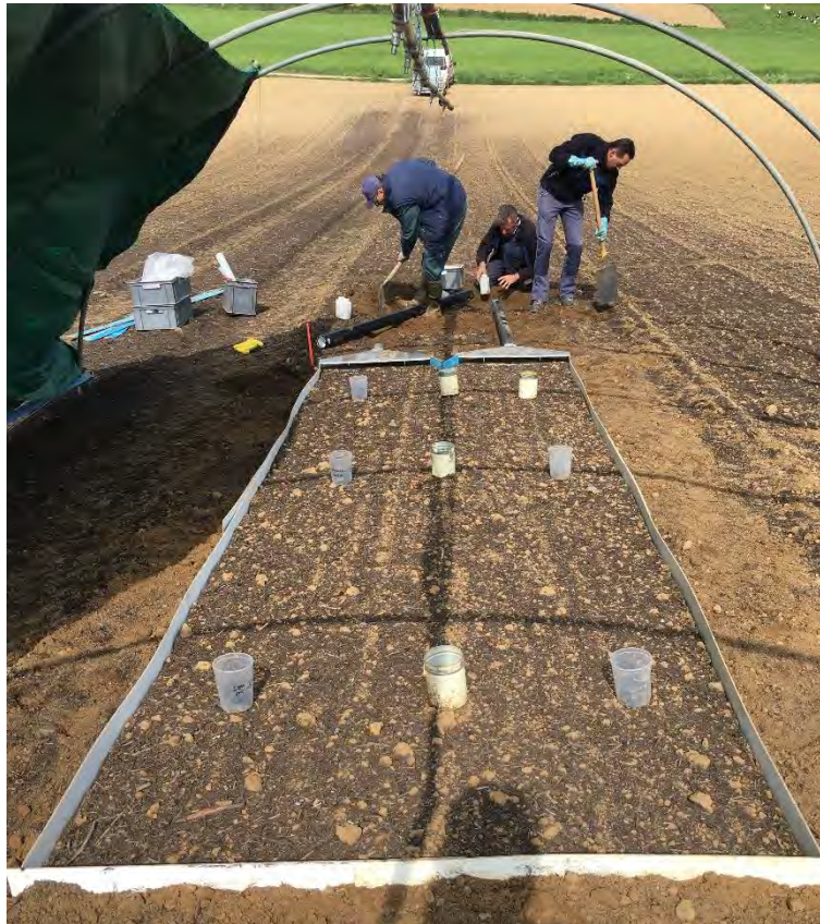
Figuur 2-16: Zicht op de erosiesimulator van UGent en een erosieveldje in de veldproef.
