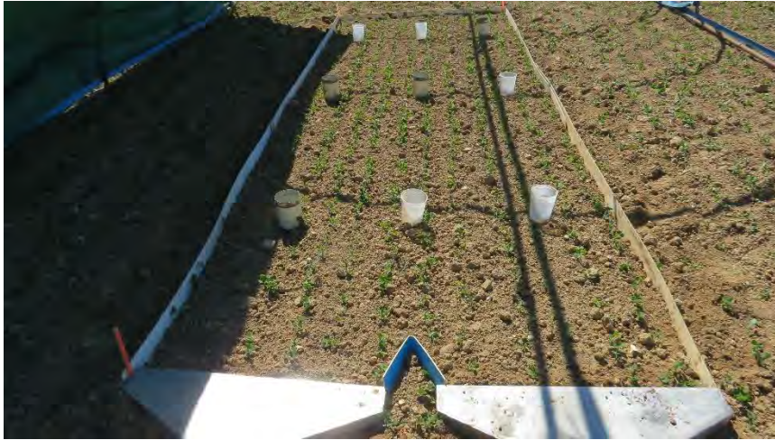
Figuur 4-9: Zicht op de erosiesimulator van UGent en een erosieveldje in de veldproef.
