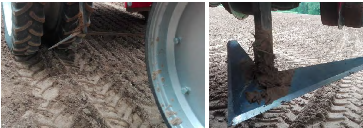
Figuur 1-13: Zicht op de banden en sporenwissers die gebruikt werden bij de klassieke maïszaaimachine.
