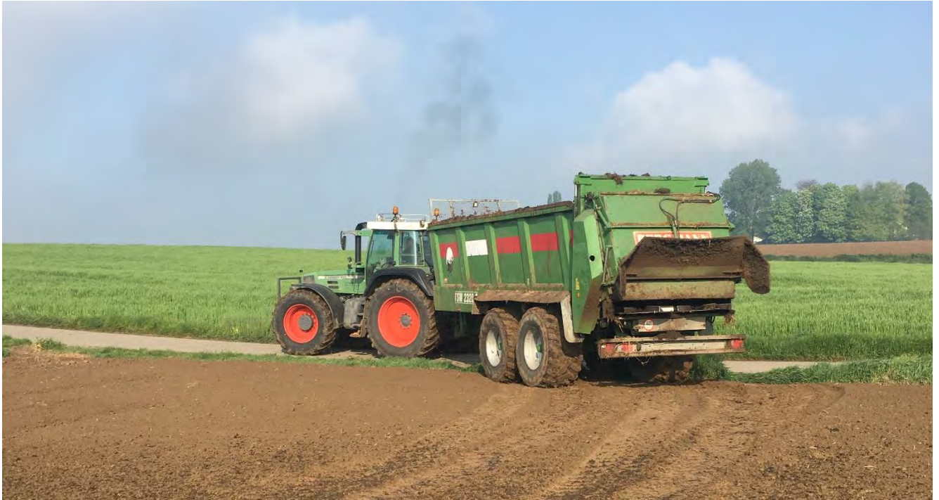
Figuur 2-7: Stalmestspreider met verticale walsen.
