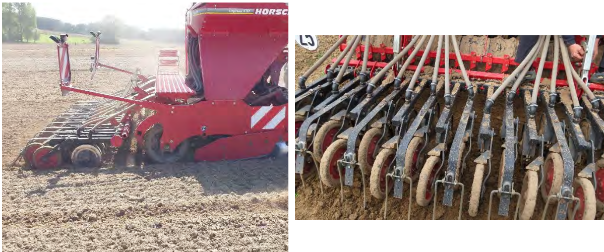
Figuur 1-14: Zicht op de Horsch zaaimachine (links) en detail van de zaaikouters (rechts).
