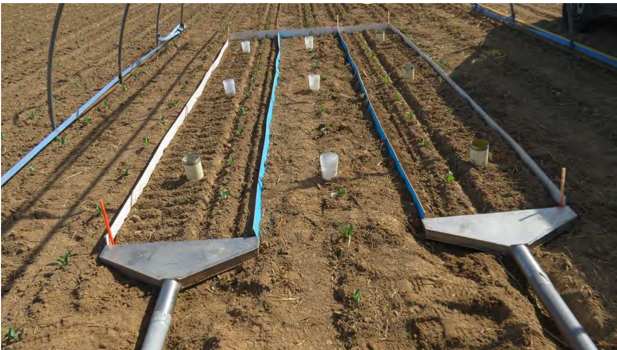
Figuur 6-14: Zicht op de erosiesimulator van UGent en een erosieveldje in de veldproef.
