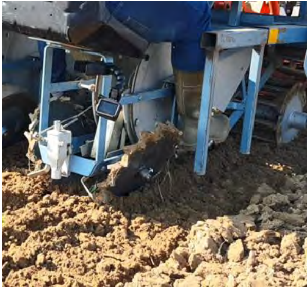
Figuur 6-9: V-press wiel type 1 en planrij aangedrukt door V-press wiel type 1 na ploegen.
