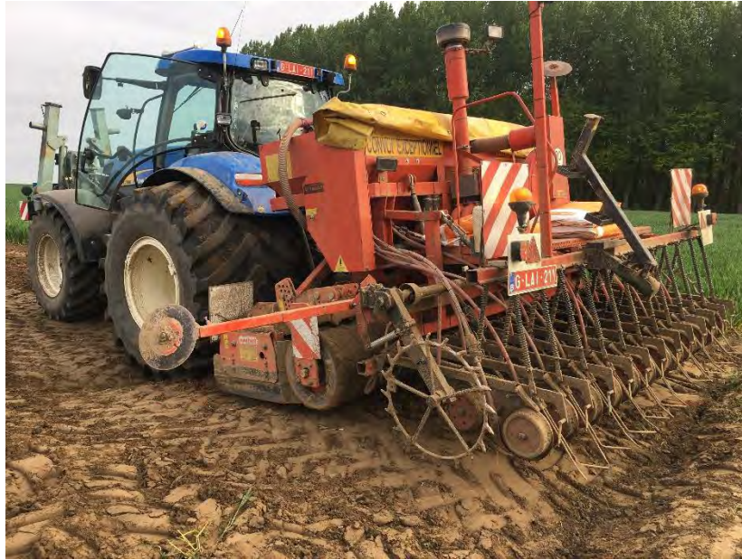
Figuur 5-1: Turbosem pneumatische zaaimachine gecombineerd met rotoleg
