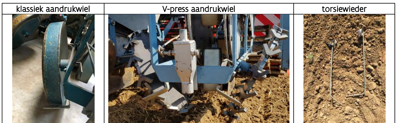
Figuur 7-6: Detailfoto's van klassiek aandrukwiél (links), V-press aandrukwiél (midden) en torsiewieder (rechts) voor op de planter.
