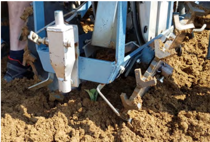
Figuur 6-10 : V-press aandrukwiël type 2 en planrij aangedrukt door V-press wiel type 2 na ploegen.
