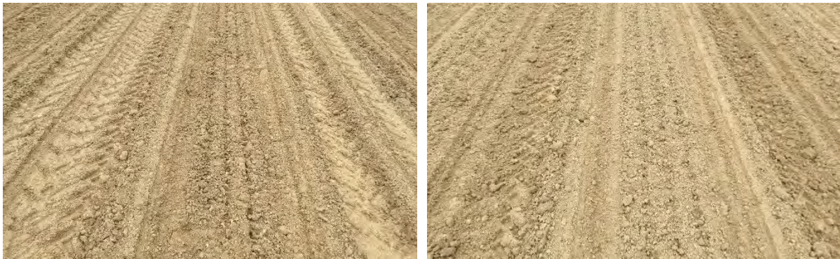
Figuur 1-12: Zicht op de bandensporen waar geen sporenwisser werd gebruikt (links) en de gedeeltelijk weggewerkte bandensporen waar wel een sporenwisser werd gebruikt (rechts).
