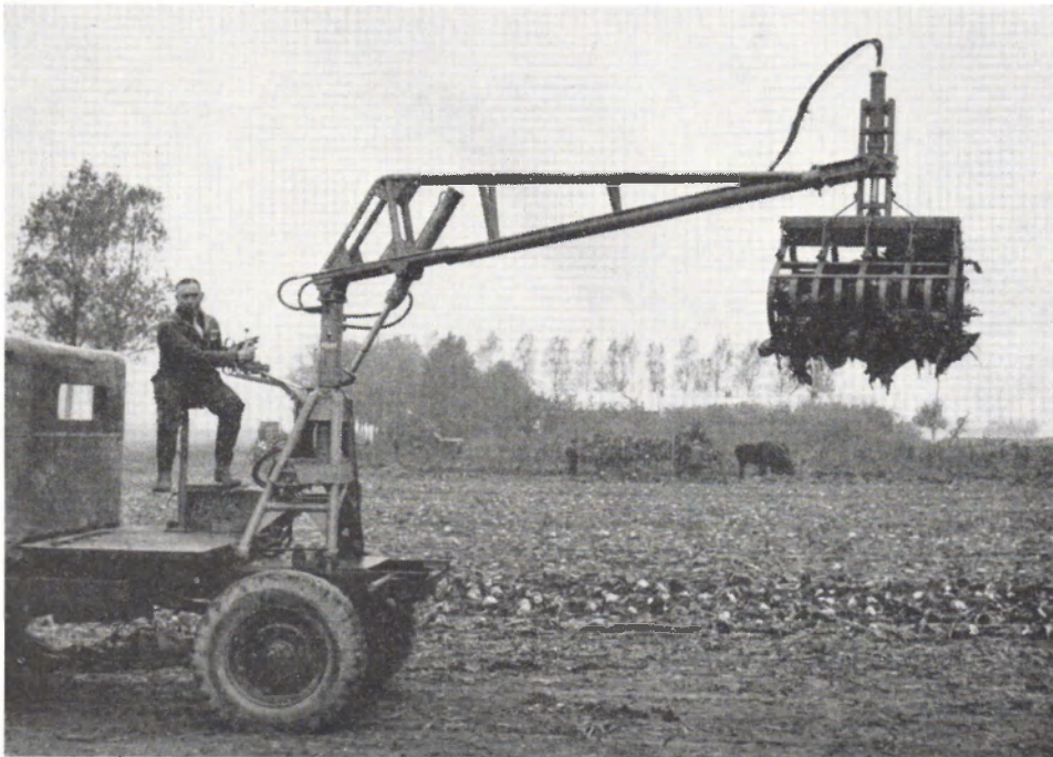
Afb. 18. Atlas hydraulische kraan met bietenknijper
