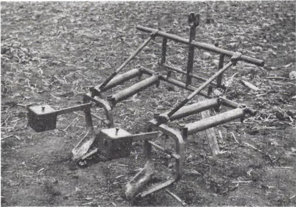
Afb. 10. Tweerijge Knipper bietenlichter voor trekkegebruik
