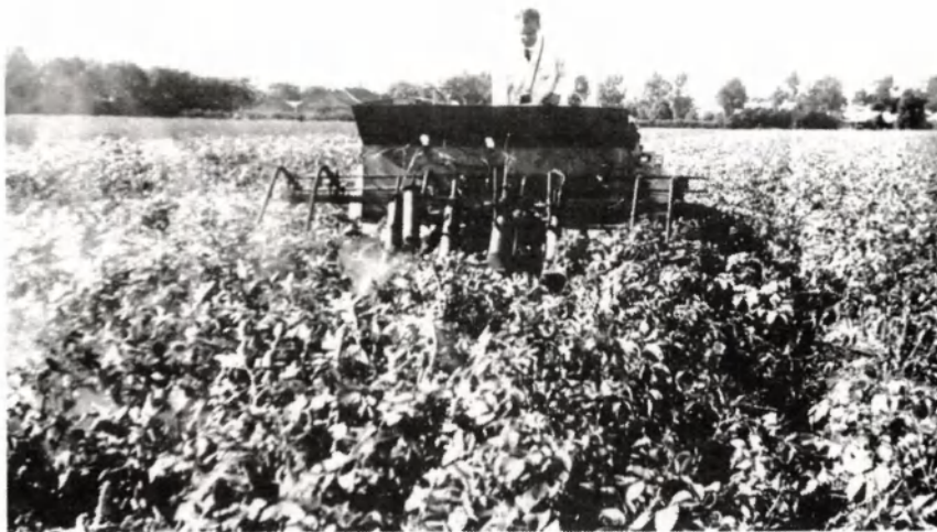
Afb. 3 Loof doodbranden met de Maywick Kerovator (4 branders per rij).
