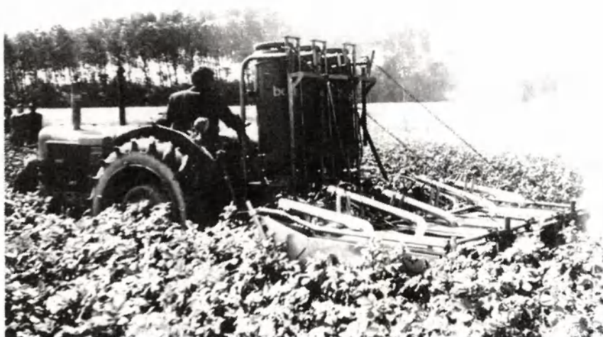
Afb. 6 De Benegas propaanvlammenspuit bij het doodbranden van loof.
